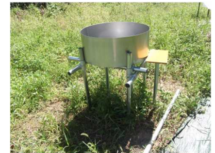
図2 水盤の設置状況
