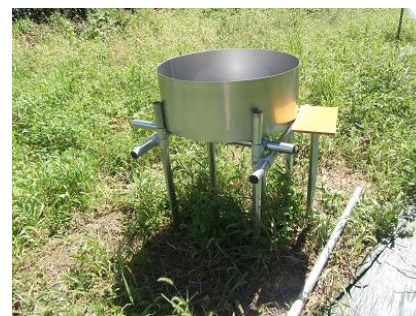
図2 水盤の設置状況
